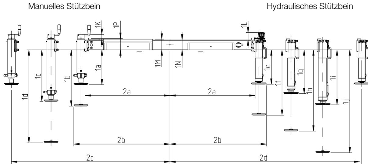
Sockel mit schwenkbaren Stützbeinen
