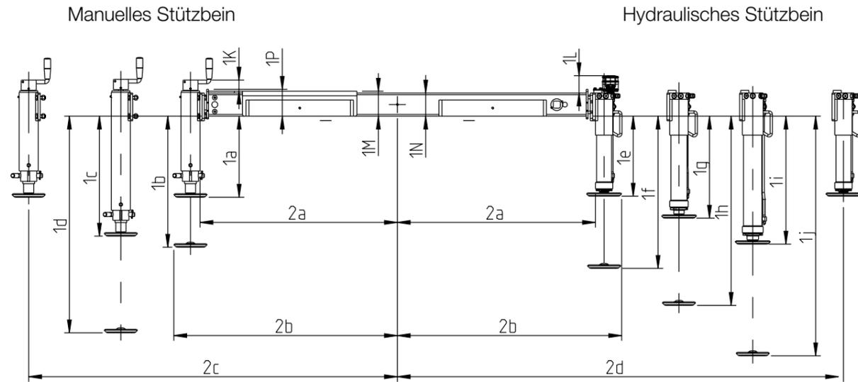
Sockel mit schwenkbaren Stützbeinen
