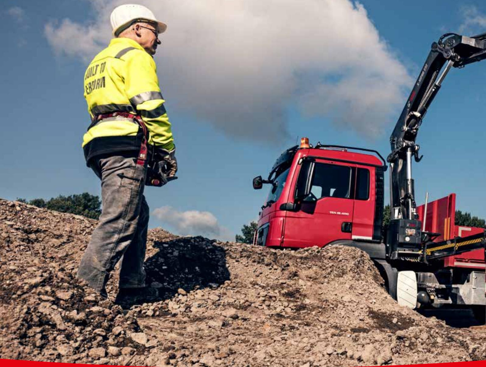
Le HIAB CombiDrive<sup>2S</sup> est livré de série avec une ceinture abdominale et une ceinture thoracique. Les deux ceintures ergonomiques soulagent les épaules et le dos de l'opérateur. Les sangles sont réalisées dans un matériau de haute qualité. Cette qualité, combinée au design de la commande à distance, permet de minimiser l'usure des sangles.
