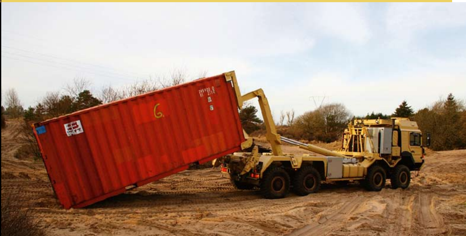
MULTILIFT MSH-165-SC-kroklastväxlare som särskilt konstruerats för försvaret och har en lyftkapacitet på 16,5 ton kommer att användas av den danska försvarsmakten.
