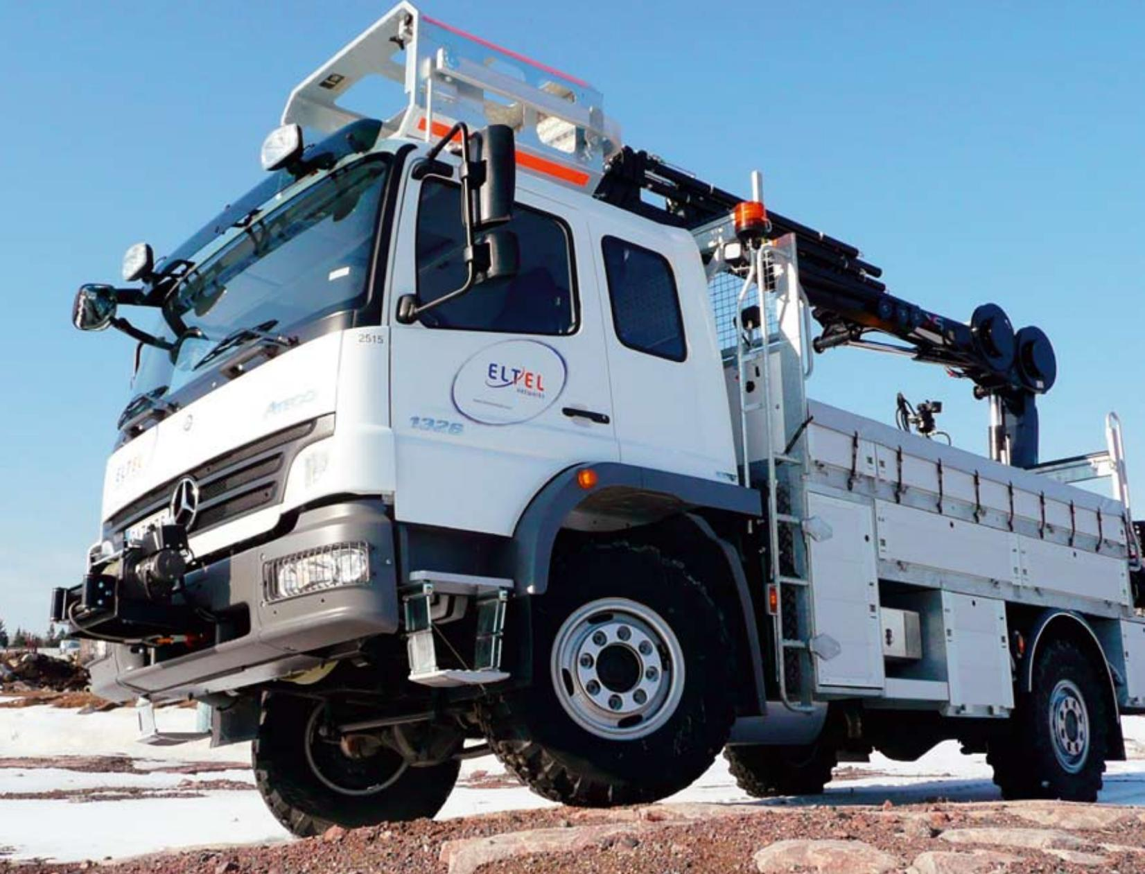
La soluzione sviluppata in vari anni di collaborazione tra la Hiab e la Veho è una struttura preallestita, progettata per il telaio Atego Mercedes-Benz a quattro ruote motrici da 13 tonnellate.
