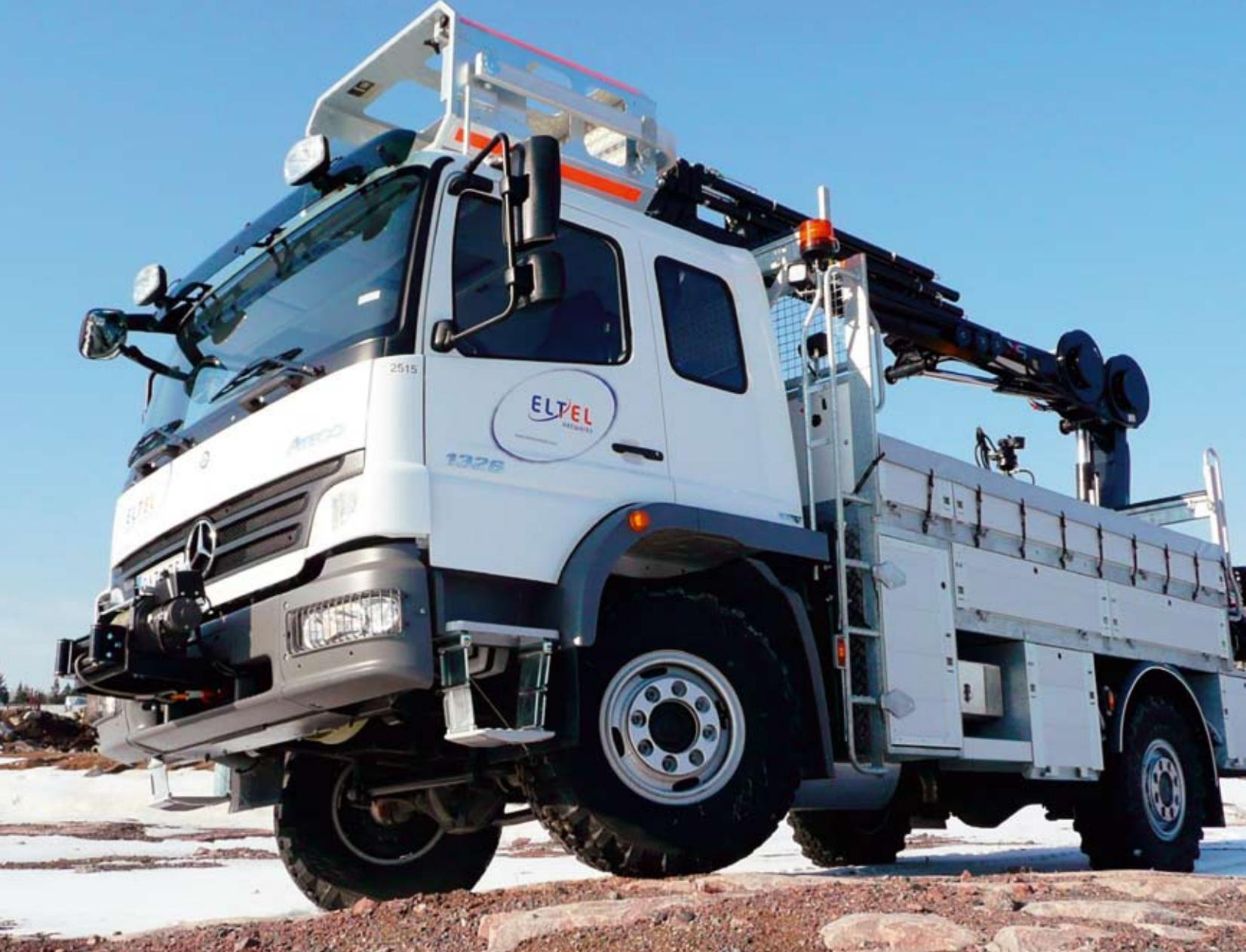
La solución desarrollada después de varios años de colaboración entre Hiab y Veho es un concepto de superestructura diseñada para el chasis del modelo de camión Mercedes-Benz Atego, de tracción a las cuatro ruedas y de 13 toneladas métricas de peso.
