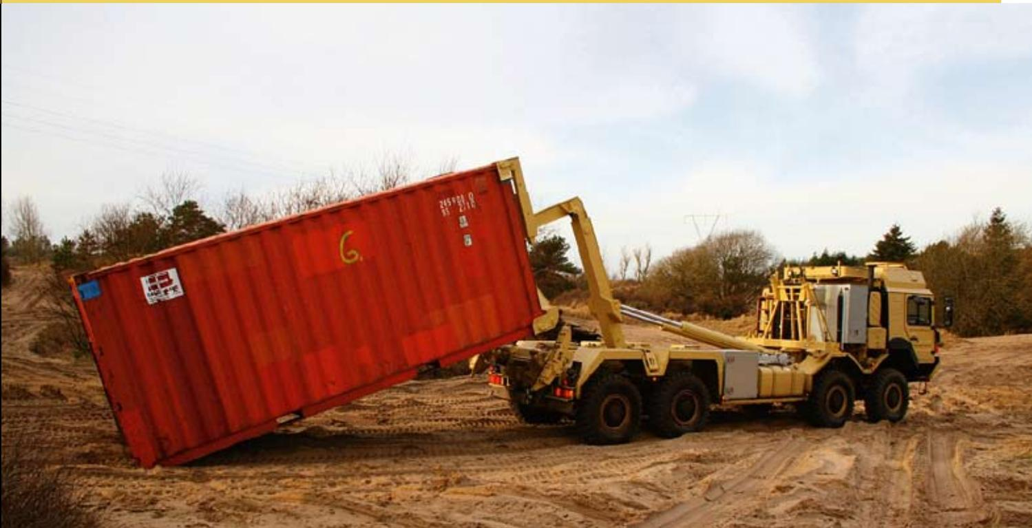
Los equipos de gancho MULTILIFT MSH 165-SC –especialmente diseñados para las fuerzas de defensa y con capacidad de elevación de 16,5 toneladas– prestarán servicio en las fuerzas de defensa de Dinamarca.
