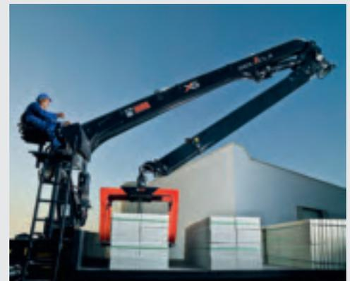
**La nouvelle grue Hiab XS 310 L est conçue pour la manutention de briques et de blocs, en particulier au Moyen-Orient. À sa portée maximale (17,5 m,) la grue Hiab XS 310 L peut soulever jusqu'à 1240 kg.**
