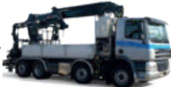
« Avec la plateforme élévatrice mobile et les grues à flèche fixe sur le même véhicule, plus besoin d'installer des échafaudages autour du puits. »
