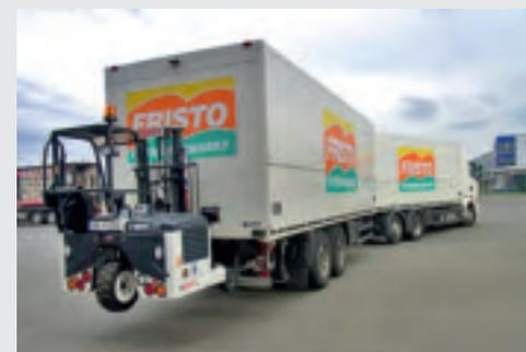
**Avec une capacité de manutention de charge de 1500 kg, le nouveau Hiab Moffett M2 15.1 a été développé pour des applications industrielles et commerciales dans lesquelles la taille, le poids et la manœuvrabilité de la machine sont essentiels.**
