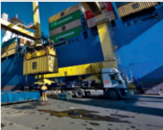
Une grue navire-terre Kalmar place le conteneur dans le navire de charge.
