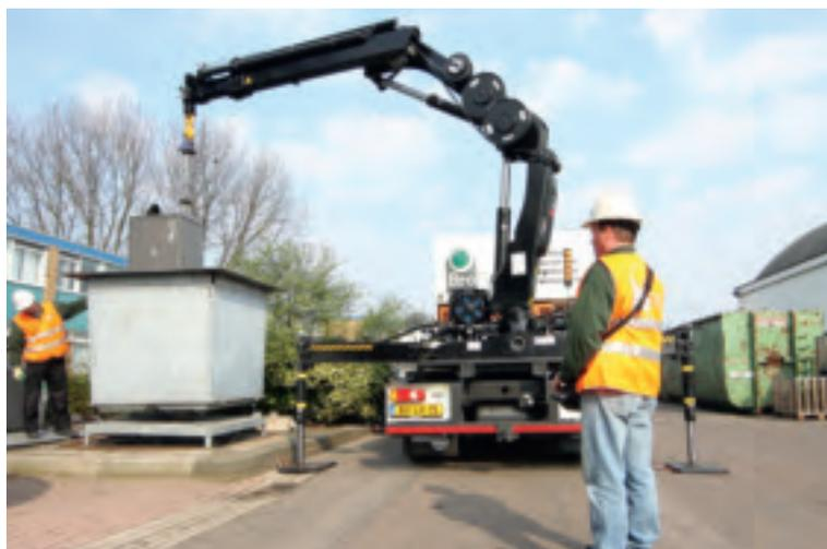
camion possède un moteur diesel EEV, plus propre pour les zones urbaines peu polluantes, point auquel nos clients accordent de plus en plus d'importance. Avec cette grue auxiliaire Hiab, nous respectons également la nouvelle Directive Machines et la norme EN 12999:2009. Nos clients connaissent bien les nouvelles réglementations, qui rentrent de plus en plus en ligne de compte lors des appels d'offres. L'essentiel est d'atteindre davantage de sécurité » explique De Nijs.
