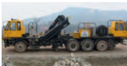
Les grues Hiab ont été installées sur des véhicules ferroutés le long du cadre de châssis.
