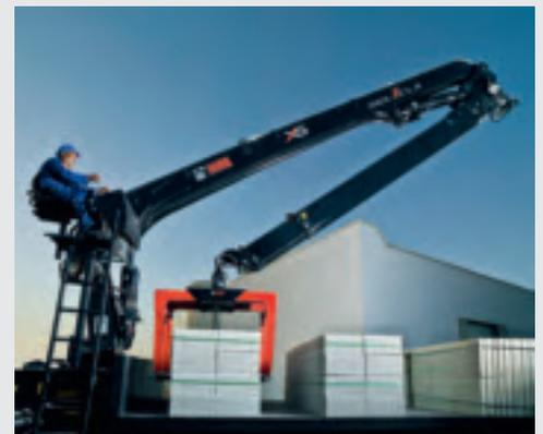
**Der neue Hiab XS 310 L wurde für die Verladung von Ziegeln und Steinen konzipiert – vor allem im Nahen Osten. Die maximale Reichweite des Krans beträgt 17,5 m, die Hubkraft 1.240 kg.**
