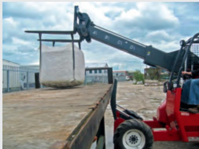
**Der neue M10 25.3 ist das erste Gerät mit einem Teleskopausleger, das für verschiedene einseitige Abladeanwendungen geeignet ist und die gleiche Ergonomie und Leistung bietet wie Modelle mit herkömmlichen Hubmasten.**
