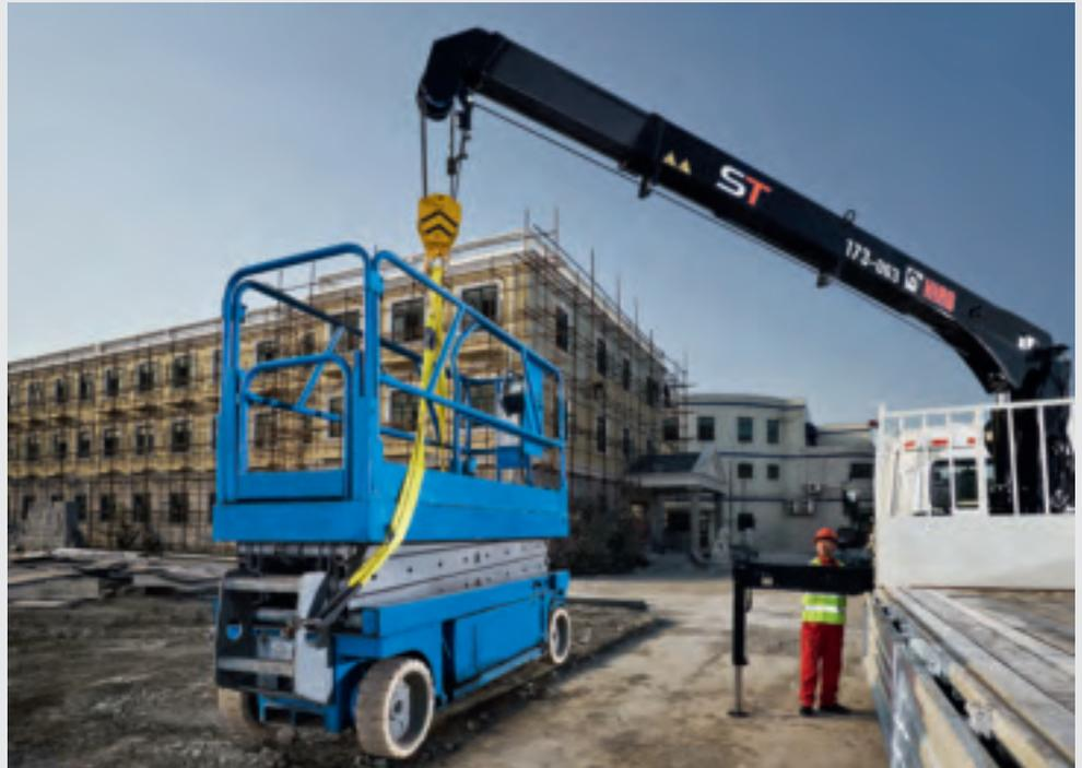
**Das erste Mitglied der neuen Familie wurde zunächst auf dem chinesischen Markt eingeführt. Der Hiab ST 173-063 mit einer horizontalen Reichweite von fast 10 m und einer maximalen Hubkapazität von 17 mt bietet für ein Fahrzeug mit zwei Achsen extrem hohe Leistung. Der Hiab ST 174-063, das neueste Mitglied der Familie mit drei Erweiterungen, weist eine höhere Reichweite von horizontal 13 m und vertikal 14 m auf. Die maximale Hubkapazität des Hiab ST 174-063 beträgt 16,4 mt.**
