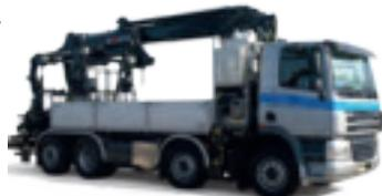
„Da sich die fahrbare Hubarbeitsbühne und die Krane mit festem Ausleger auf demselben Fahrzeug befinden, ist neben dem Bohrloch kein Gerüst erforderlich.“
