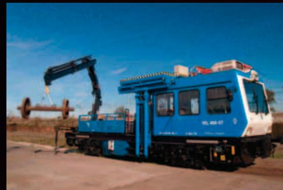
Vagoneta de servicio autopropulsada VEL 400, dotada de una grúa de carga HIAB 122 XS E4 HiPro.
