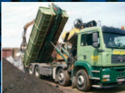
**Austria.** La combinación de equipo de gancho MULTILIFT LHZ con grúa JONSERED para reciclaje es la de uso más común en Austria.
