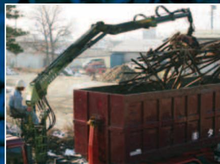
**Japón.** Para la recolección y transporte de diversas clases de cargas de residuos se puede usar la versátil combinación de grúa LOGLIFT con un equipo de gancho MULTILIFT de 10 toneladas de capacidad.
