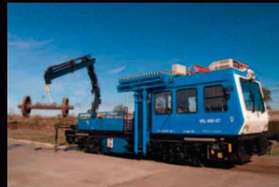
VEL 400, ein Wartungszug mit eigener Stromquelle, ausgestattet mit HIAB XS 122 E4 HiPro Ladekran.
