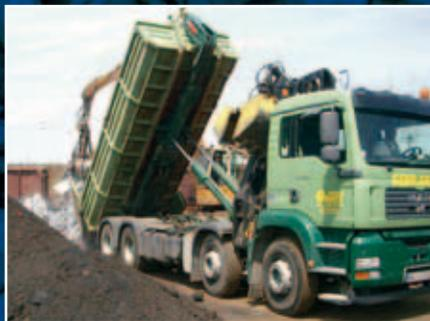
**Österreich.** Die Kombination MULTILIFT LHZ-Hakengerät und JONSERED-Recyclingkran wird in Österreich bevorzugt eingesetzt.
