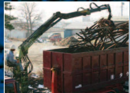
**Japan.** Diese vielseitige Kombination aus einem LOGLIFT-Kran und einem MULTILIFT-Hakengerät mit einer Kapazität von 10 Tonnen lässt sich für ganz unterschiedliche Abfall- und Recyclingtransporte verwenden.
