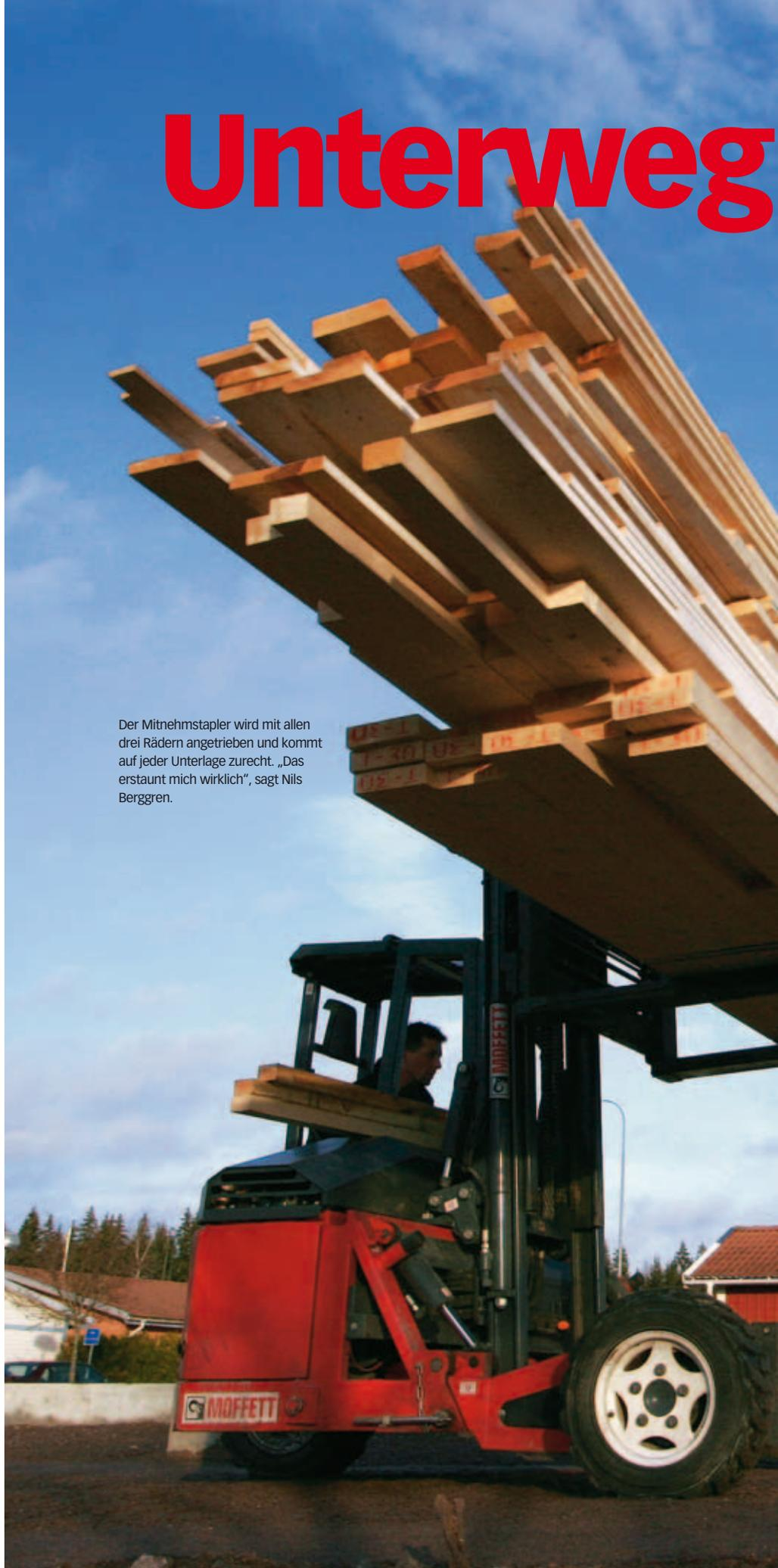
Der Mitnehmstapler wird mit allen drei Rädern angetrieben und kommt auf jeder Unterlage zurecht. „Das erstaunt mich wirklich“, sagt Nils Berggren.
