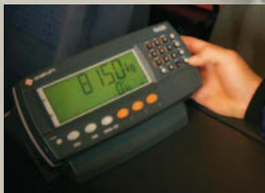
основание для выписки счетов, как, например, в сфере сбора и переработки отходов, то данная система должна быть сертифицирована. Сертификат оборудования был получен у независимого органа: измеренный вес соответствует реальному весу груза, а для грузовиков отпадает необходимость проезда через автомобильные весы.
