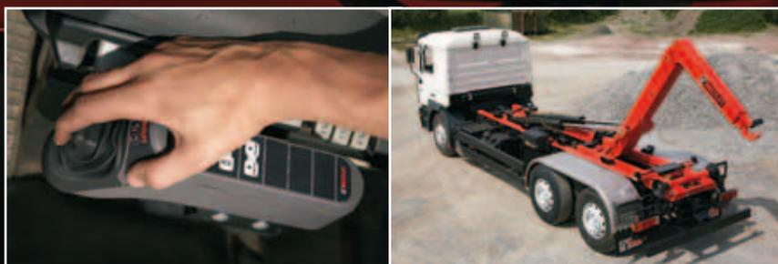
► trollo automatico opzionale insieme al controllo manuale: quando l'operatore sposta la leva nella posizione più estrema, l'equipaggiamento disattiva il sistema di bloccaggio idraulico della cassa, porta il gancio in posizione orizzontale e lo sposta dietro il camion per sollevare la cassa dal suolo. Con la leva nella posizione opposta, l'equipaggiamento solleva da terra la cassa, la spinge sul camion ed infine attiva il sistema di bloccaggio della cassa.
